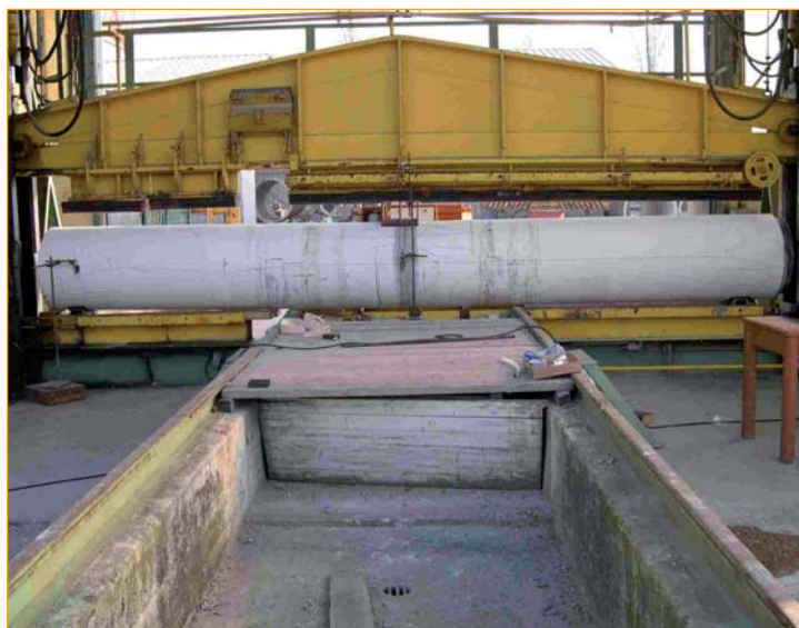
Figure 2 : Essai mécanique de flexion réalisé pour valider les simulations.
