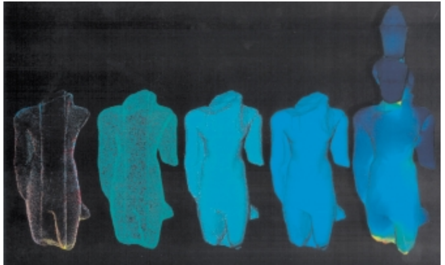
1 Du maillage de surface obtenu par scannage 3D au calcul mécanique
