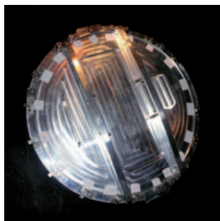
Figure 1 : Tape GV mécano-vissée (étriers de sécurité non mis en place).
