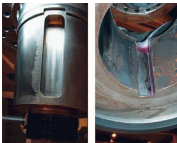
Figure 2 : Fretting sur le cône de l'arbre et sur la roue.
