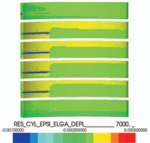
Figure 3 : Déformations en intrados dans la zone de béton atypique au cours du scénario APRP.
