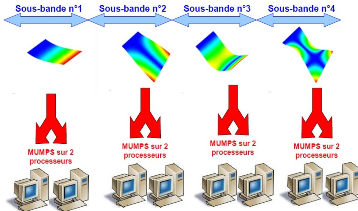
Figure 3.11-1. Exemple de distribution des calculs d'INFO\_MODE sur 8 processeurs avec un découpage en 4 sous-bandes fréquentielles.
