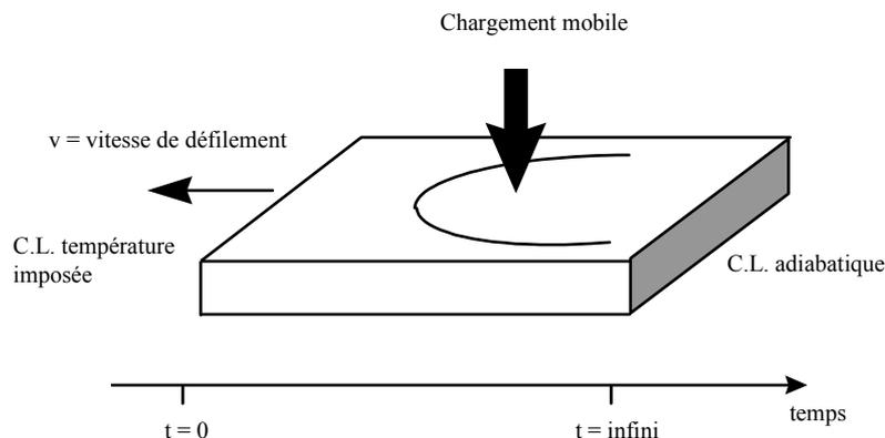
*Ainsi, en aval dans l'espace (tôt dans le temps), la condition aux limites sur le bord de la pièce doit imposer la température de la pièce avant que n'arrive le chargement mobile. En amont dans l'espace (ou tard dans le temps), un flux thermique nul (adiabaticité) garantit l'hypothèse de stationnarité.*
