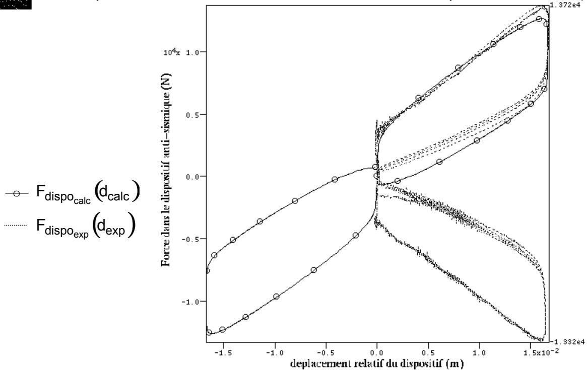
SDND120 - Réponse transitoire d'un dispositif anti-sismique - 09/11/2011
