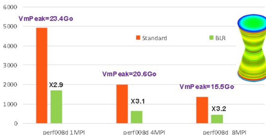
Figure 7.2-2: Exemple de gains procurés par les compressions low-rank sur le cas test de performance perf008d (paramètres par défaut, gestion mémoire en OOC, N=2M , NNZ=80M , Facto\_METIS4=7495M , conditionnement=10^7 ). On trace, en fonction du nombre de processus MPI activés, les temps elapsed consommés par toute l'étape de résolution de système linéaire dans Code_Aster v13.1, son pic mémoire RAM, ainsi que le facteur d'accélération procuré par BLR.
