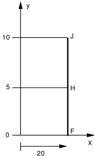
La géométrie discrétisée est représentée ci-dessus. On choisit la théorie de coques de Love-Kirchhoff (pour cela on prend un coefficient de cisaillement transverse de  $10^6$ ). On néglige la correction de métrique dans l'épaisseur. L'épaisseur est de  $1\text{ mm}$ .
