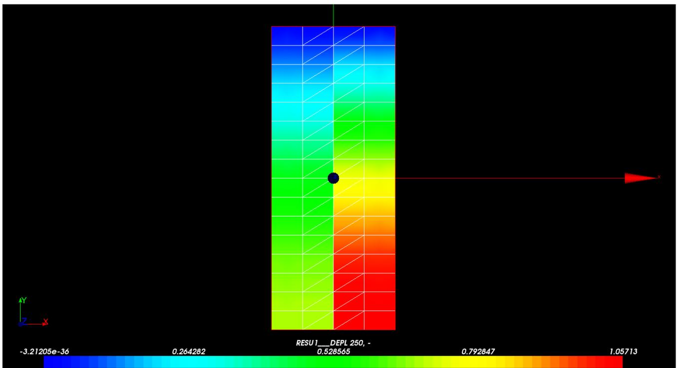
Dans la colonne de droite, on teste la pression de pore PRE1 et la contrainte SIYY à l'instant final  $t=250s$  à différentes hauteurs dans la colonne. Les résultats obtenus sont similaires à ceux obtenus pour une modélisation D\_PLAN\_HM classique mais légèrement moins précis que ceux obtenus avec une modélisation D\_PLAN\_HMD classique dans le haut de la colonne.
