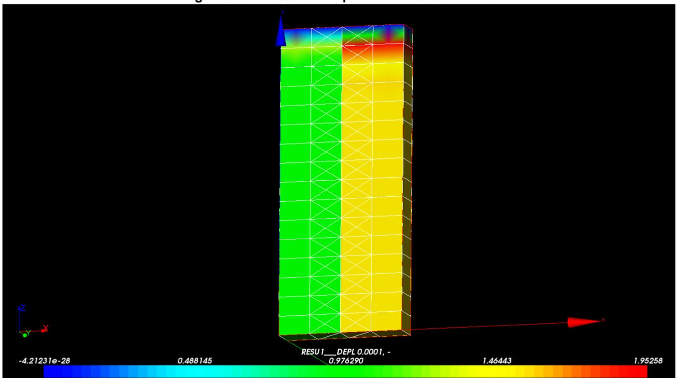
Dans la colonne de droite, on teste la pression de pore PRE1 à l'instant  $t=0,0001s$  à différentes hauteurs dans la colonne. Les résultats obtenus sont similaires à ceux obtenus pour une modélisation 3D\_HM classique mais légèrement moins précis que ceux obtenus avec une modélisation 3D\_HMD classique dans le haut de la colonne.
