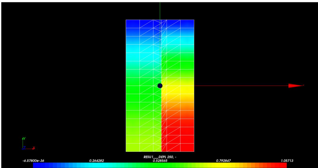
Dans la colonne de droite, on teste la pression de pore PRE1 et la contrainte SIYY à l'instant final  $t = 250s$  à différentes hauteurs dans la colonne. Les résultats obtenus sont similaires à ceux obtenus pour une modélisation D\_PLAN\_HM classique mais légèrement moins précis que ceux obtenus avec une modélisation D\_PLAN\_HMD classique dans le haut de la colonne.
