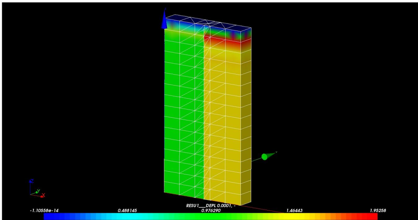
Dans la colonne de droite, on teste la pression de pore PRE1 à l'instant  $t=0,0001s$  à différentes hauteurs dans la colonne. Les résultats obtenus sont similaires à ceux obtenus pour une modélisation 3D\_HM classique mais légèrement moins précis que ceux obtenus avec une modélisation 3D\_HMD classique dans le haut de la colonne.
