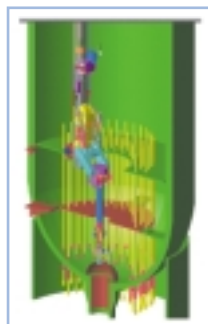
Vue de l'outil de lançage (opération de décontamination de la manchette thermique de la tubulure d'expansion)
